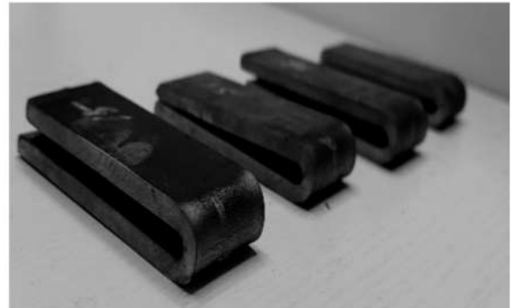
图 6 AG650LW 钢 4.6 mm 板 D = 1.0a 的冷弯试验
