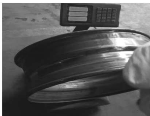
图 8 轻量化 650 MPa 高强度 AG650LW 钢轮辋形貌
